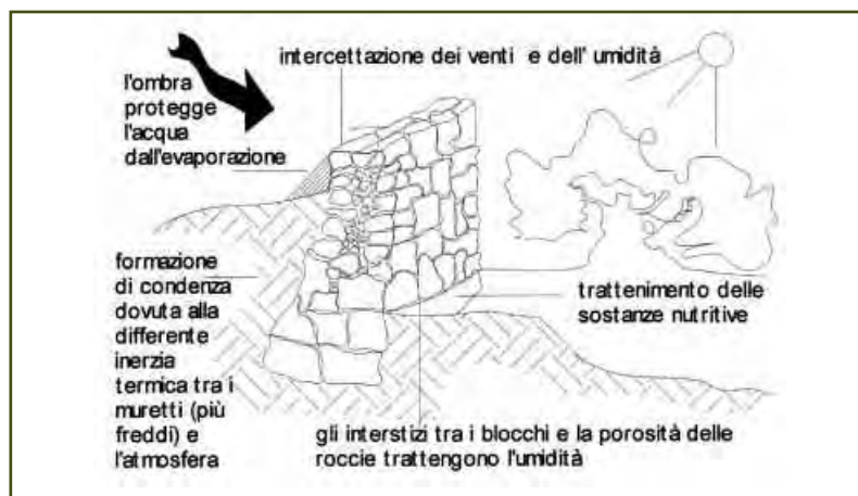
Fig. 3.3.21 Il muro a secco e la complessità del suo funzionamento dal punto di vista climatico e culturale, si noti il "parapetto" (da FARINA, 2003).
